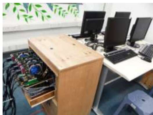
图 5 制作计算机柜，移接 LED 灯、开关制和总电源开关至枱面
