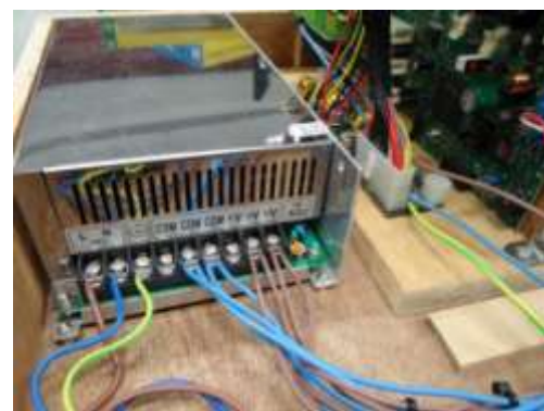
图 7 1 个 12V 500W 40A 电源供应 4 部主机
