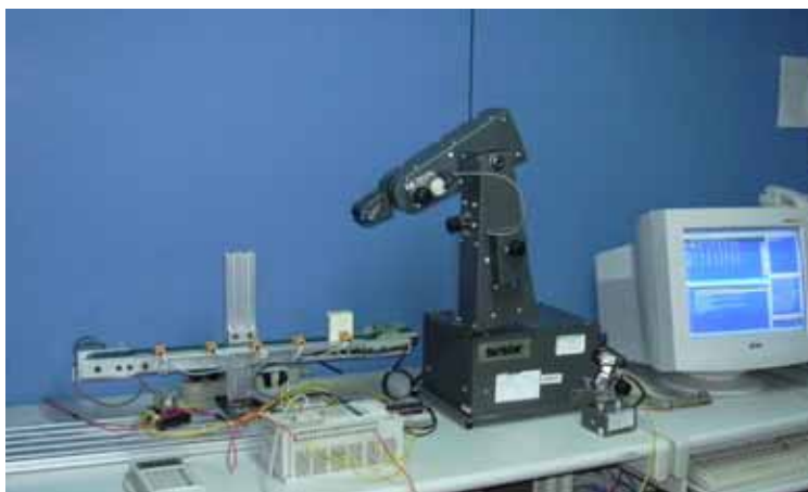
圖 8 輸送帶與機械手臂組合之「物件輸送實習」設備
