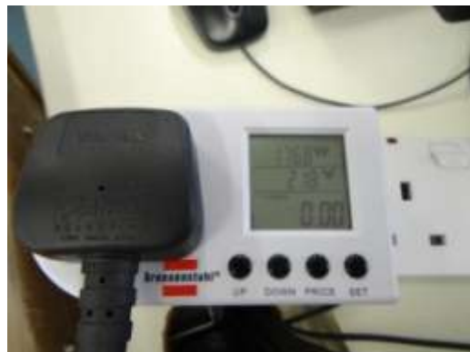
图 11 4 部计算机备用状态用电值 177W
