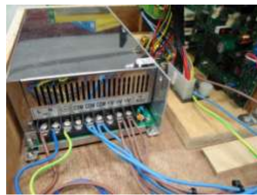
图 7 1 个 12V 500W 40A 电源供应 4 部主机
