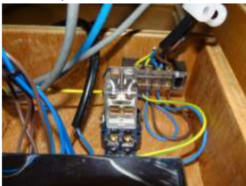
图 8 继电器开关设计，提高用电安全性
