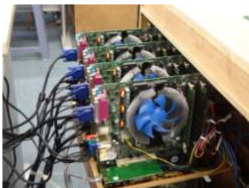
图 6 高密度装置 4 部主机，导向式风冷散热设计
