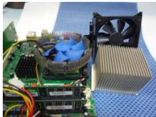
图 3 更换轻巧的 CPU 风扇，增加内存
