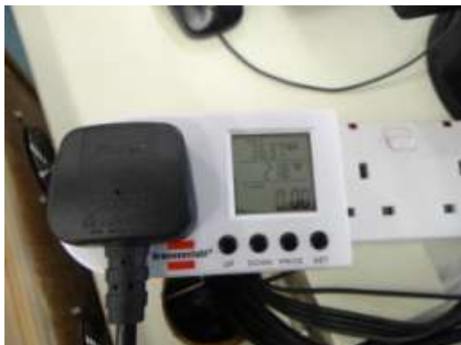
图 10 4 部计算机用电峰值 364W
