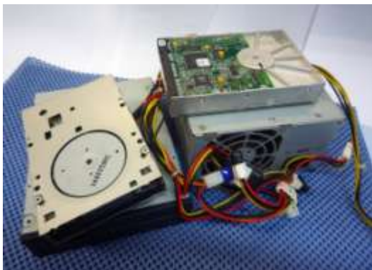
图 2 移除磁盘驱动器、硬盘、光驱和变压器
