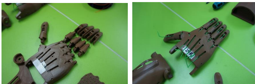
圖 14：左邊是通過設計後，可用立體打印製作義肢，再需手動打磨調整及穿針引線，最後完成右邊的義肢作品。
